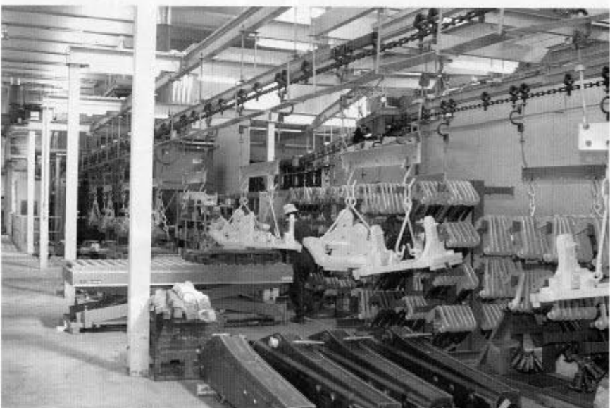
Fig. 13 - I pezzi, così rifiniti, vengono avviati - durante il percorso dall'uscita del forno si raffreddano - allo scarico
