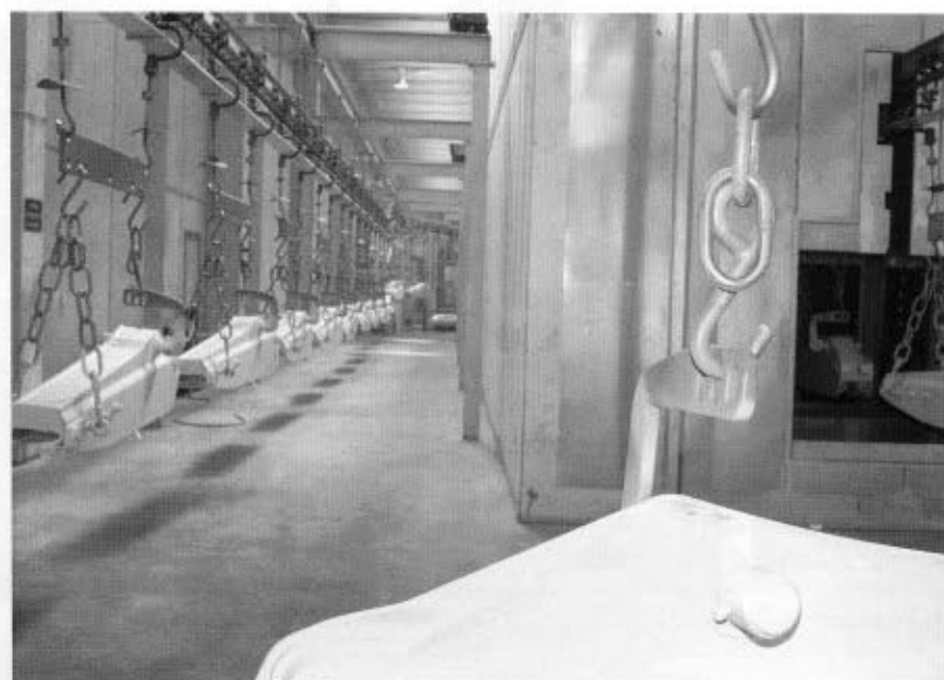
Fig. 10 - Sulla destra si intravedono i pezzi primerizzati all'uscita dal forno di cottura del film protettivo ottenuto da fondo poliestere idrosolubile: a sinistra, i pezzi nella zona di raffreddamento a temperatura ambiente
