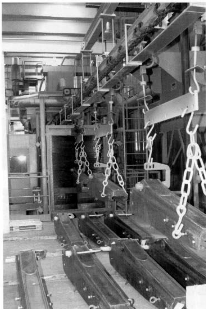
Fig. 7 - Particolare dell'ingresso dei pezzi nel tunnel di granigliatura a metallo bianco per la eliminazione totale della calamina e altri prodotti di arrugginimento
