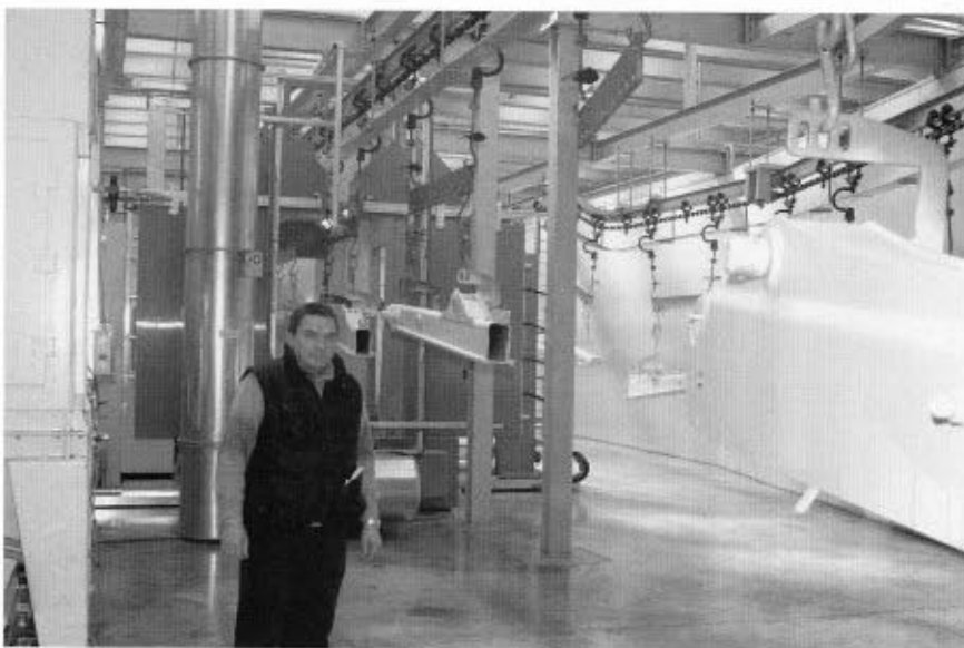
Fig. 11 - Particolare dell'ingresso dei pezzi primerizzati nella cabina a polveri: P.P. Pellegrini ci ha accompagnato nella visita all'impianto
