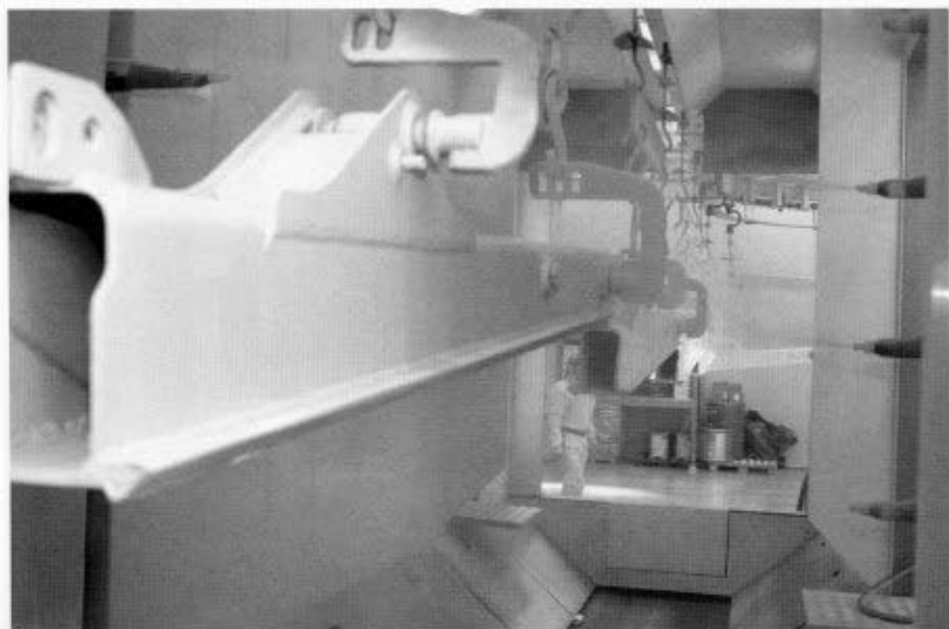
Fig. 21 - Particolare dell'interno cabina durante la spruzzatura automatica di polveri: essa è dotata anche di area specifica per eventuale ritocco manuale
