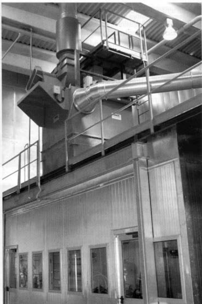
Fig. 8 - All'uscita del tunnel di granigliatura i pezzi sono introdotti nella cabina di soffiaggio, qui illustrata, per la necessaria pulizia delle polveri di abrasivo rimaste depositate sui pezzi: in alto è installato l'impianto di depolverazione
