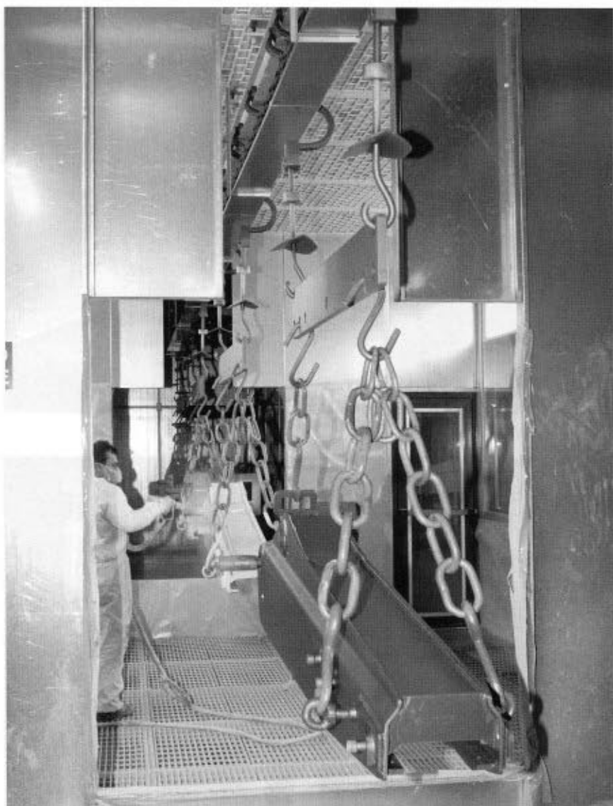
Fig. 9 - Applicazione della mano di fondo anticorrosivo all'acqua in cabina con aspirazione dell'overspray a pavimento
